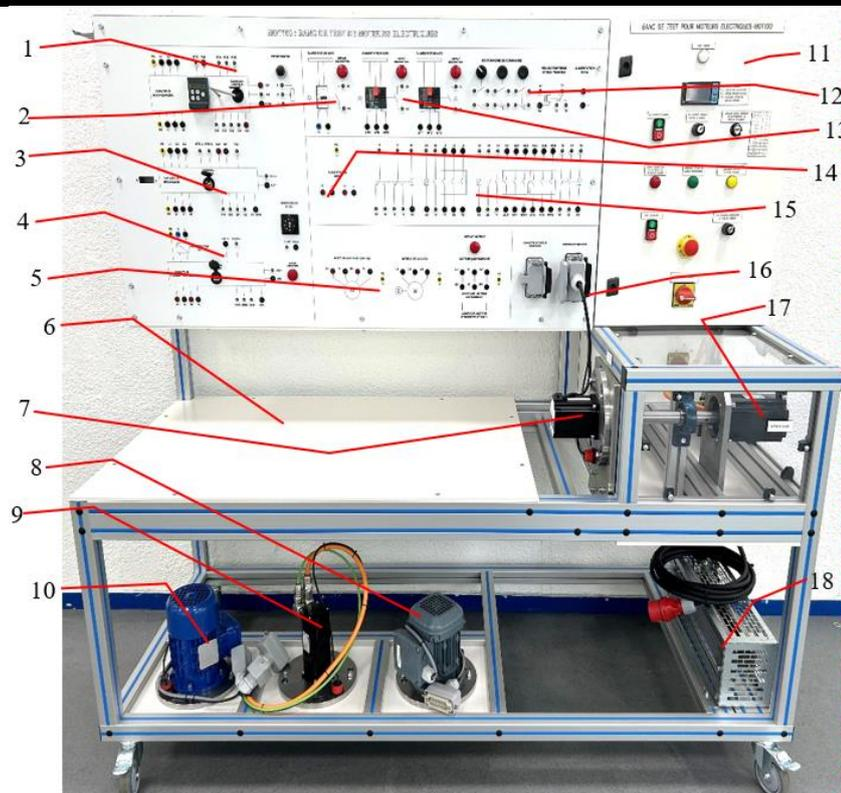
1. VARIATEUR TRIPHASE réf ATV320-0.55KW POUR MOTEUR (A)SYNCHRONES + POTENTIOMETRE DE REGLAGE VITESSE (Câble de raccordement à un PC fourni)
