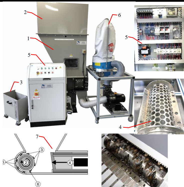
Détail du cylindre (2) avec ses outils (3)
