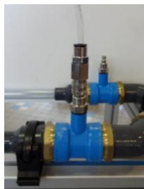
Illustration d'une prise de pression par raccord rapide auto obturant
