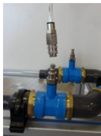
Illustration d'une prise de pression par raccord rapide auto obturant
