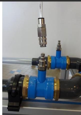
Illustration d'une prise de pression par raccord rapide auto obturant sur le circuit hydraulique
