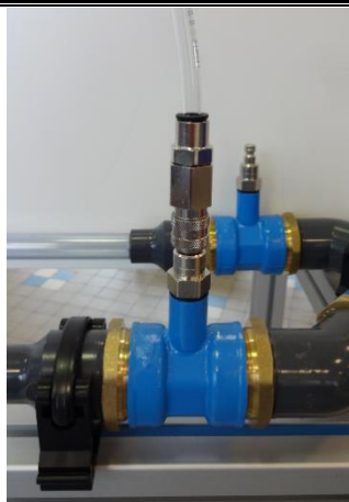
Illustration d'une prise de pression par raccord rapide auto obturant sur le circuit hydraulique
