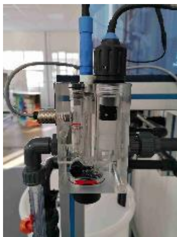
Option GPBT73 : Système de régulation de Chlore avec sonde Cl2 et sonde de pH
