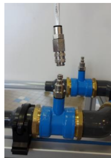
Illustration d'une prise de pression par raccord rapide auto obturant de type STAUBLI
