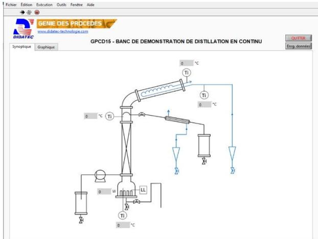
On retrouve dans cette fenêtre le synoptique de la machine avec la localisation des différentes mesures du processus et leurs valeurs.
