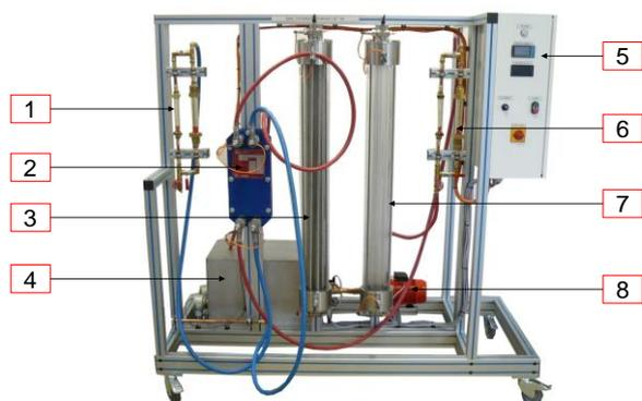
1. **Débitmètres d'eau froide avec vanne de réglage** à pointeau et vanne de sélection du débitmètre utilisé. Echelles : 15-150L/h et 100-1000 L/h.
