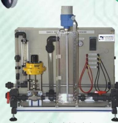
Banc de contrôle et régulation de niveau
