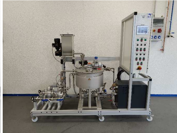
Photo cuve de recette
