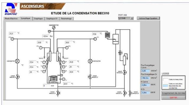
On retrouve dans cette fenêtre le synoptique de la machine avec la localisation des différentes mesures du processus et leurs valeurs.
