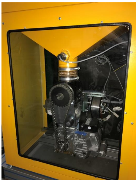
Système mécanique d'alimentation en granulés
